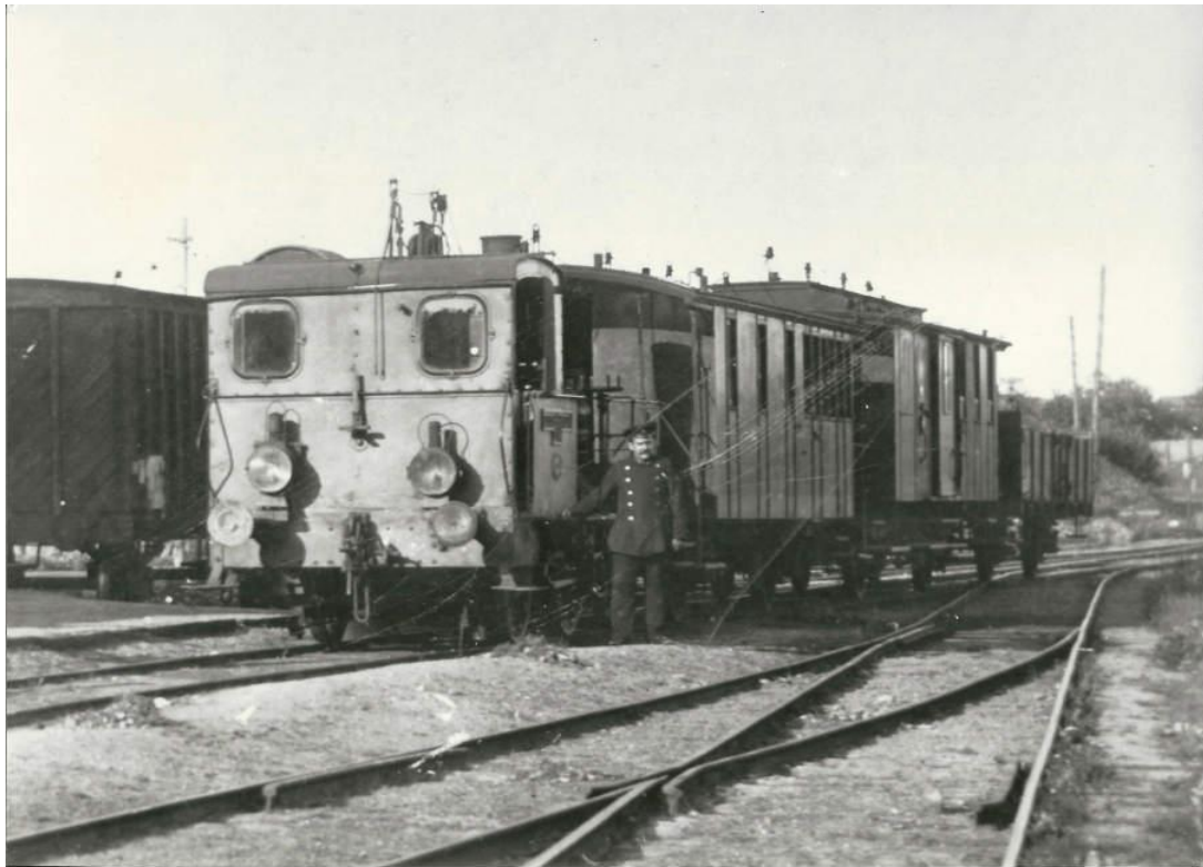
Bild 1: B n2-Tenderlokomotive von Krauss (Baujahr 1885) vor gemischtem Zug bestehend aus Wagen 93 (BCi), 92 (BCPwPosti) und offenem Wagen in Ahrensbök um 1910. (Foto Slg. H.-H. Kloth)
