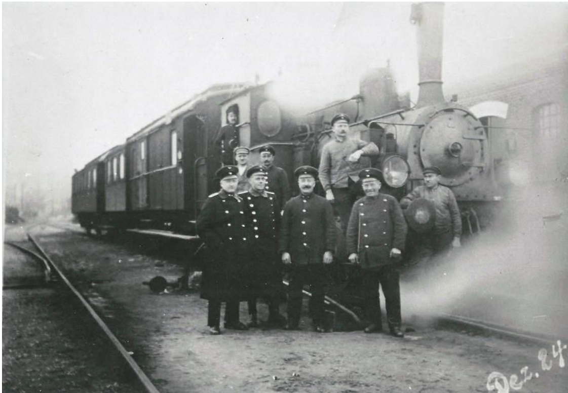
Bild 6: Bedienstete des Bahnhof Ahrensböök und eine Privatperson haben sich im Dez. 1924 für ein Erinnerungsfoto positioniert. Der Nebenbahnzug mit den Wagen 95 (DPwPost3i) und 97 (BC3i) wird von einer B n2-Tenderlokomotive von Borsig (Baujahr 1903) befördert. (Foto Slg. H.-H. Kloth)
