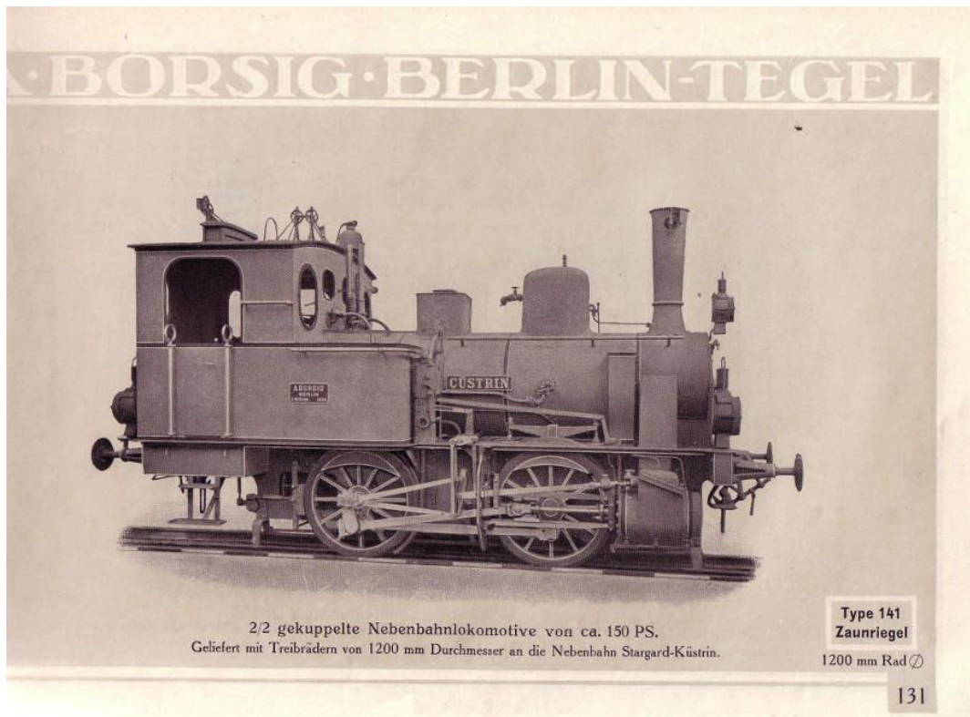
Bild 5: Werkaufnahme der B n2-Tenderlokomotive "Cüstrin" (Borsig 5144/1903) der Stargard-Cüstriner Eisenbahn. Diese Lokomotive lief als Eutin-Lübeck Nr. 10 II von 1912 bis 1926 auf der Nebenbahn. (Repro aus Borsig-Katalog "Leichte Lokomotiven" - Slg. H.-H. Kloth)
